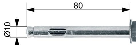
Отверстие под анкер-болт М8/10х80 - Ø10 мм и глубиной не менее 90 мм
